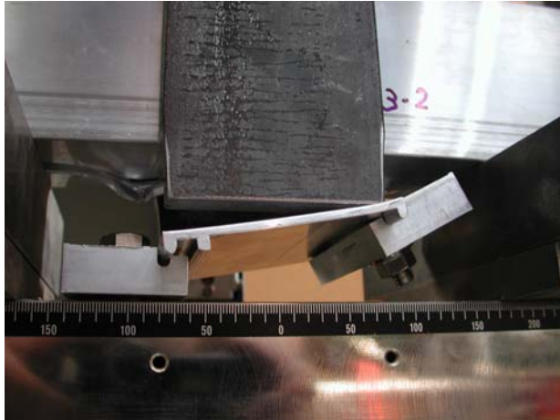
Bild 3.8 Deformation unmittelbar nach dem Bruch
