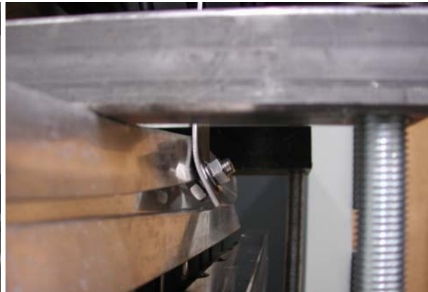
Bild 1.2 Scherbelastung senkrecht zur Schraubenachse
