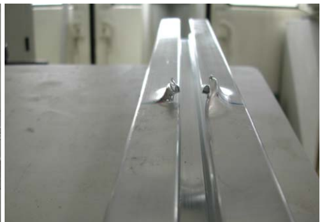
Bild 3.4 lokale Deformation des Strangpressprofils
