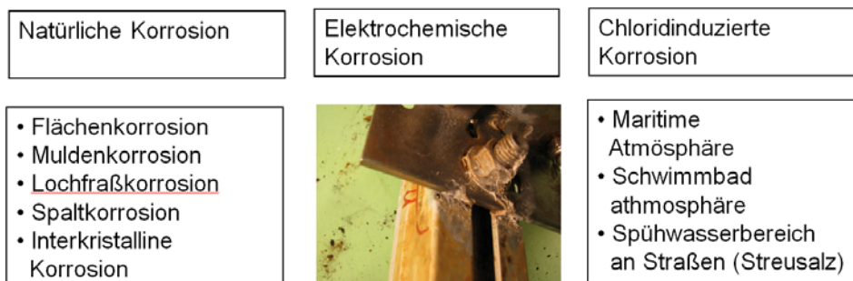
Bild 1 Korrosionsarten und Ursachen für Korrosion
