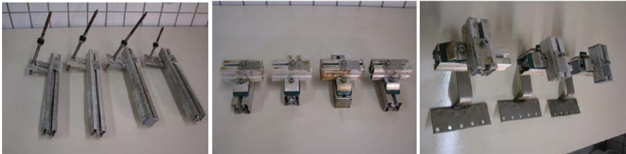
Bild 7 Versuchskörper verschiedener Befestigungsdetails nach erfolgreicher Salzsprühnebelprüfung
